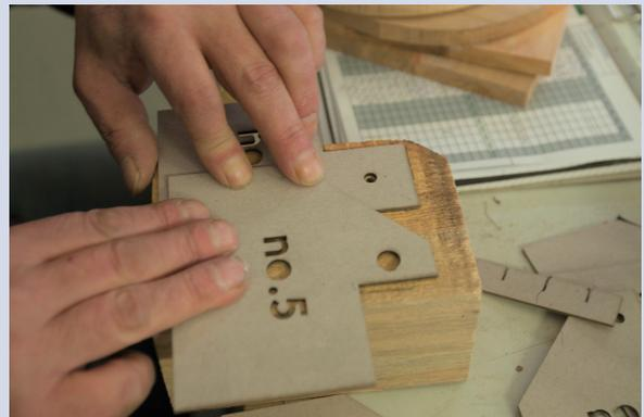
Fertigung eines Upcycling-Produktes mithilfe von Schablonen (IfaS, 2018)
